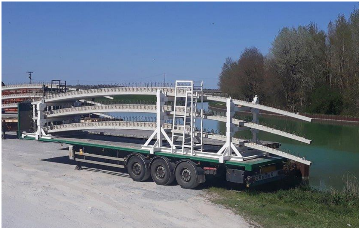
Les racks de transport mis au point par Demathieu Bard permettent de superposer trois pétales.
